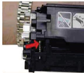
On replace ensuite les deux capots sur les côtés sans oublier de les revisser. Avant de remettre la cartouche dans l'imprimante, changez la puce et remplacez la par une nouvelle. Pour accéder à la puce coupez les rebords en plastique se trouvant sur les côtés. Dans la mesure où la nouvelle ne tiendrait pas correctement, mettez un peu de colle sur le haut. Votre cartouche est désormais prête à être utilisée.
