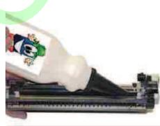
Il ne vous restera plus qu'à remettre le tout en place en suivant les instructions à l'envers : remettre la racle, le rouleau de développement avant de remettre les capots sans oublier les trois engrenages !
